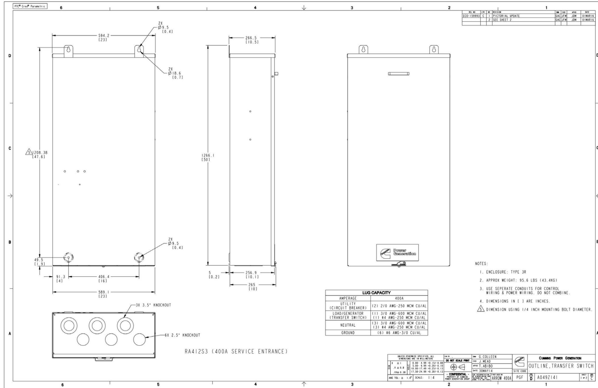
FIGURE 53. RA412S3 CONTROL BOX OUTLINE DRAWING
