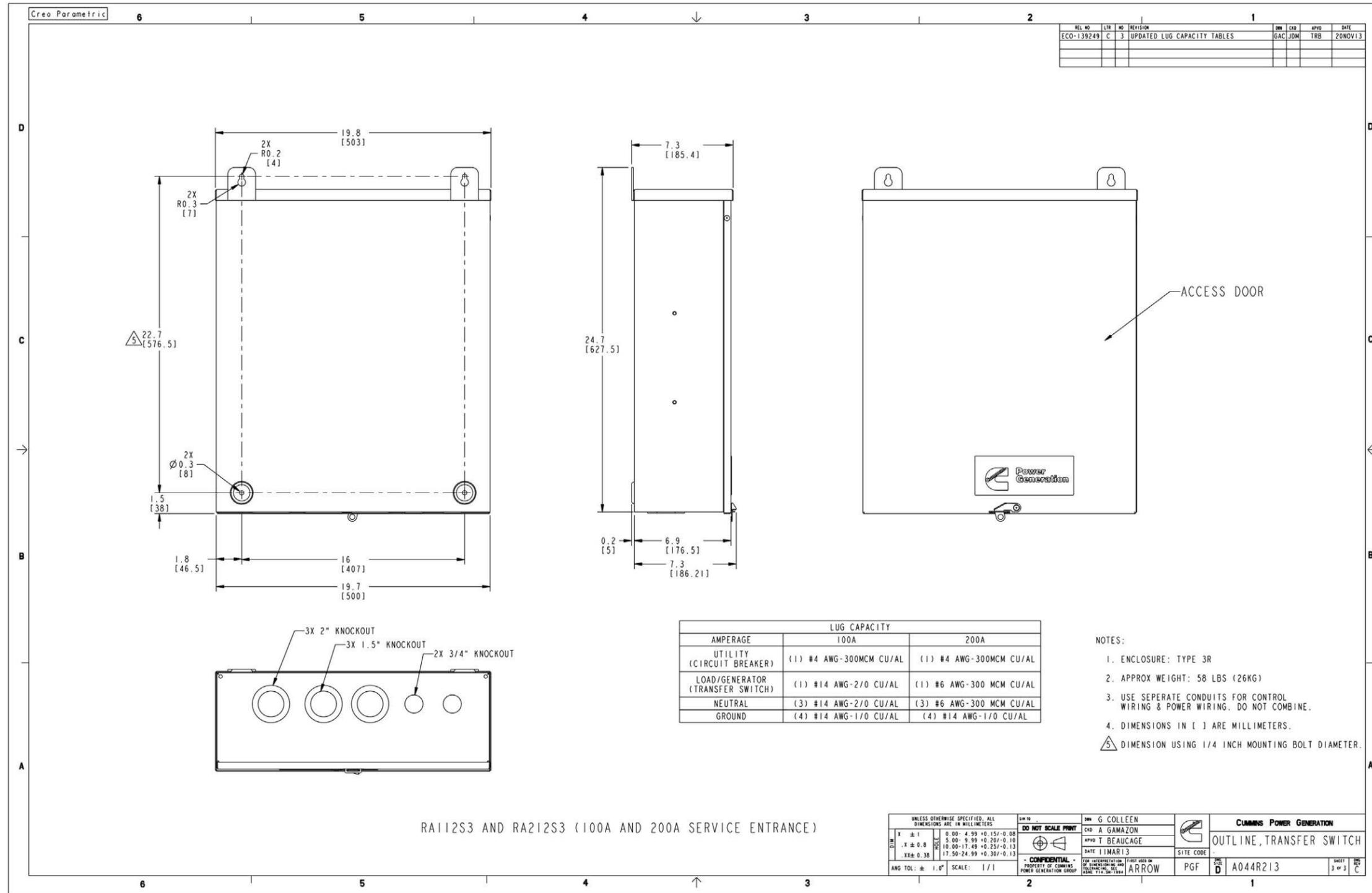
FIGURE 51. RA112S3 AND RA212S3 CONTROL BOX OUTLINE DRAWING
