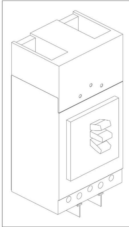
FIGURE 31. RA412S3 CIRCUIT BREAKER
