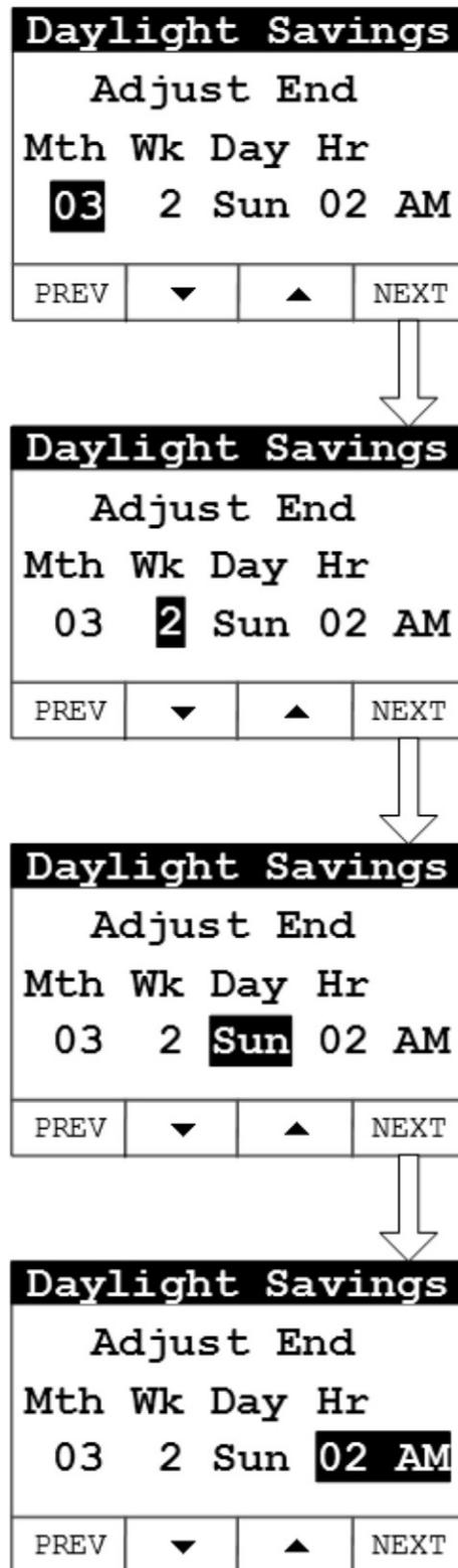
**FIGURE 25. DAYLIGHT SAVINGS TIME (END TIME SETUP)**
