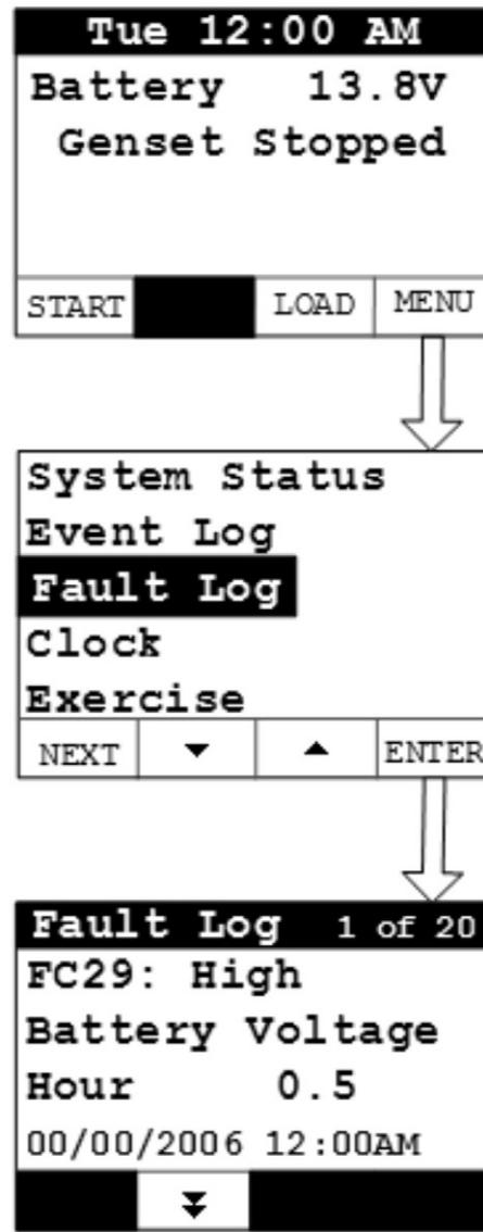
FIGURE 30. FAULT LOG SCREEN
