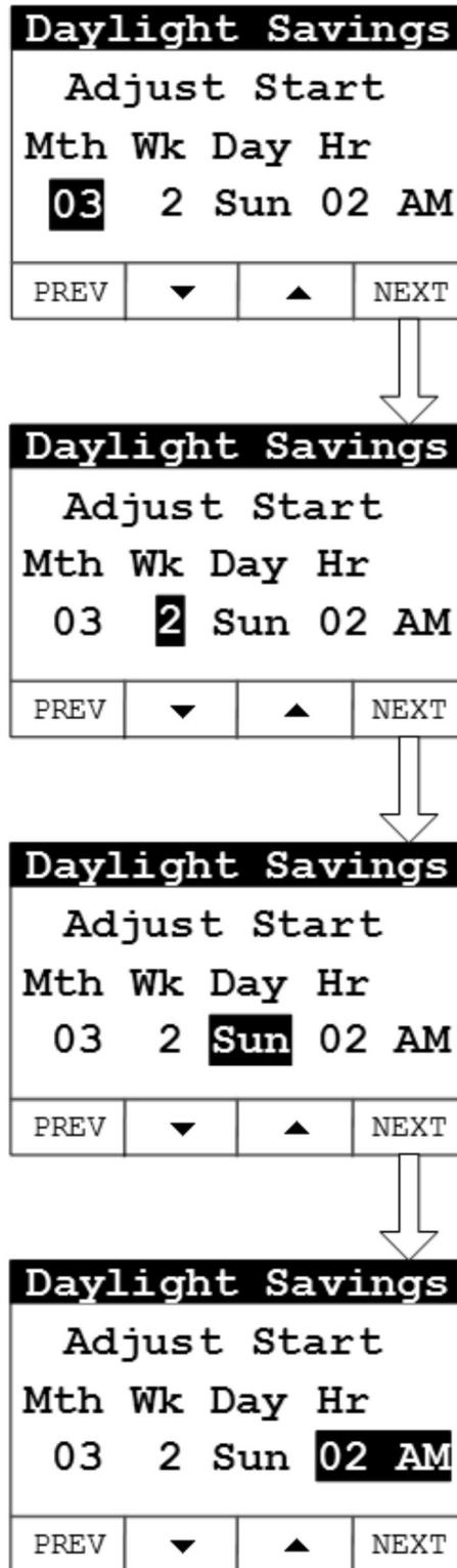
**FIGURE 24. DAYLIGHT SAVINGS TIME (START TIME SETUP)**
